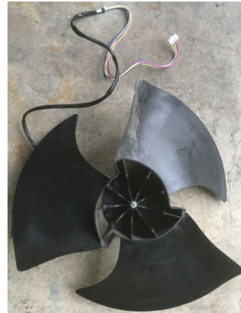
Remove the fan motor assembly
